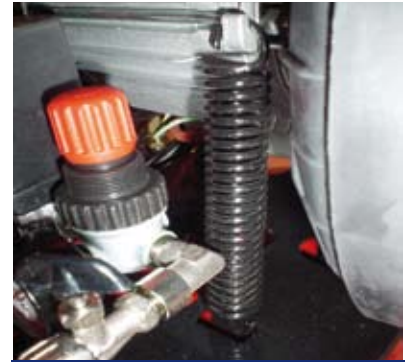
Sistema tensado motor. Tension motor system.
