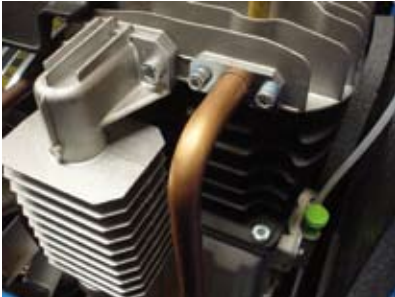
Cabezal doble etapa. Air pump two stages.
